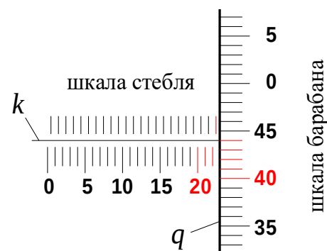
Рис. 5.3. Шкалы микрометра (измеренный размер 22,94 мм)
