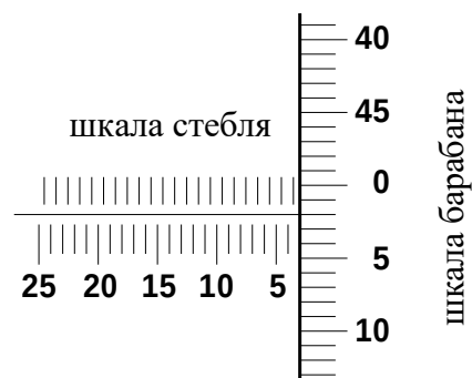
Рис. 5.5. Показания микрометрического инструмента
