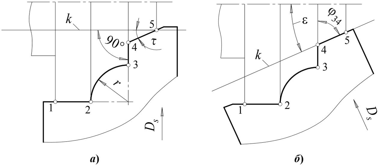
Рис. 4.13. Ортогональный (а) и неортогональный (б) фасонные резцы
