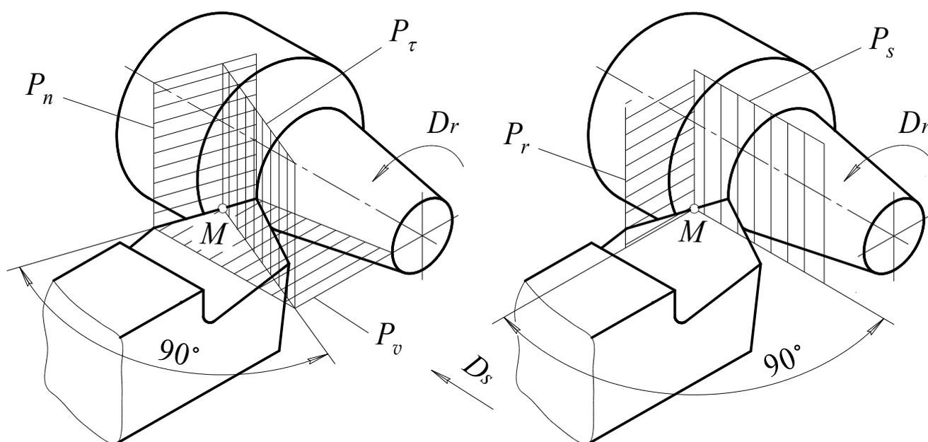
Рис. 2.2. Система плоскостей при резании
