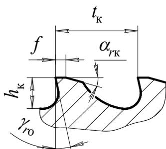
Рис. 4.29. Калибрующий зуб протяжки
