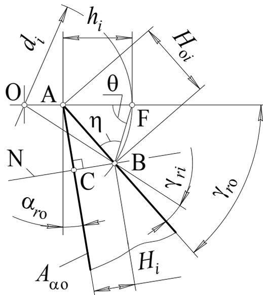
Рис. 4.6. К определению высоты шлифуемого профиля призматического реза
