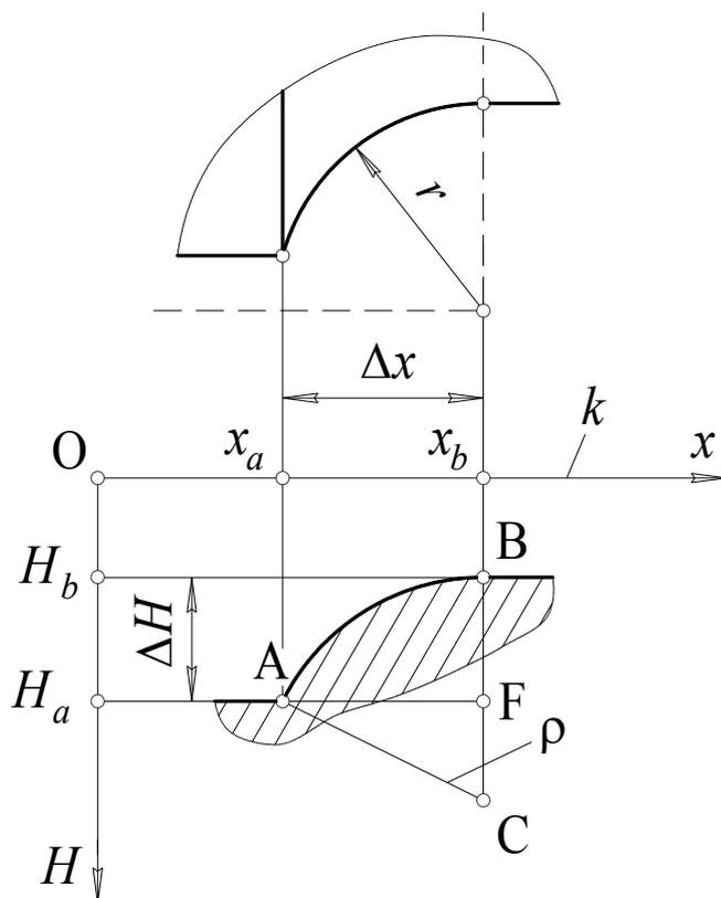
Рис. 4.9. К определению радиуса кругового участка на шлифуемом профиле фасонного резца (I вариант)
