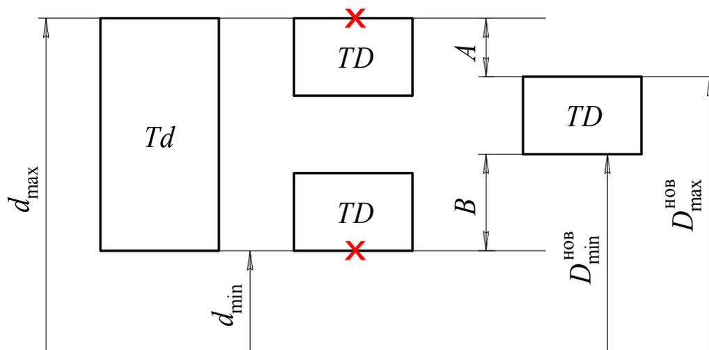
Рис. 3.10. Расположение поля допуска развертки
