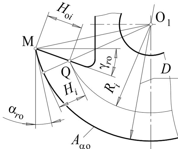
Рис. 4.7. К определению высоты шлифуемого профиля круглого резца
