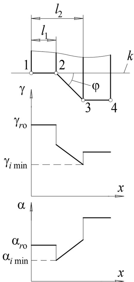
Рис. 4.4. Изменение углов вдоль профиля фасонного резца
