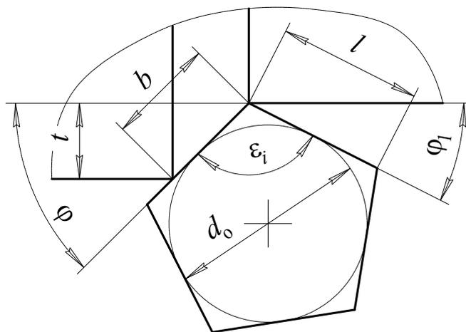
Рис. 3.2. К выбору параметров сменных многогранных пластин
