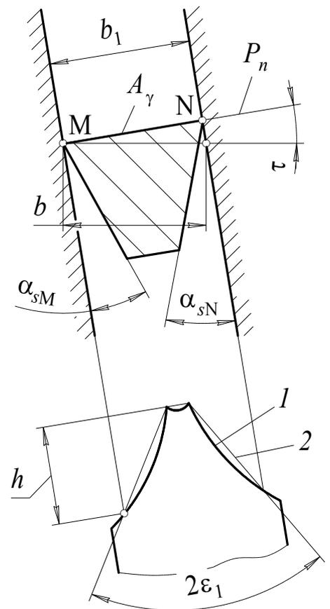
Рис. 4.17. Резьбовой резец II типа
