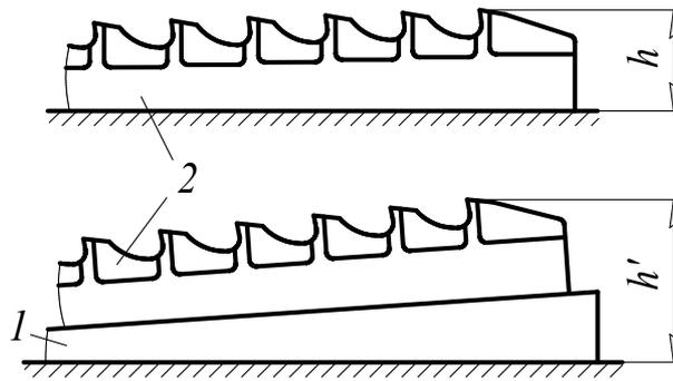
Рис. 4.24. Регулировка протяжки
