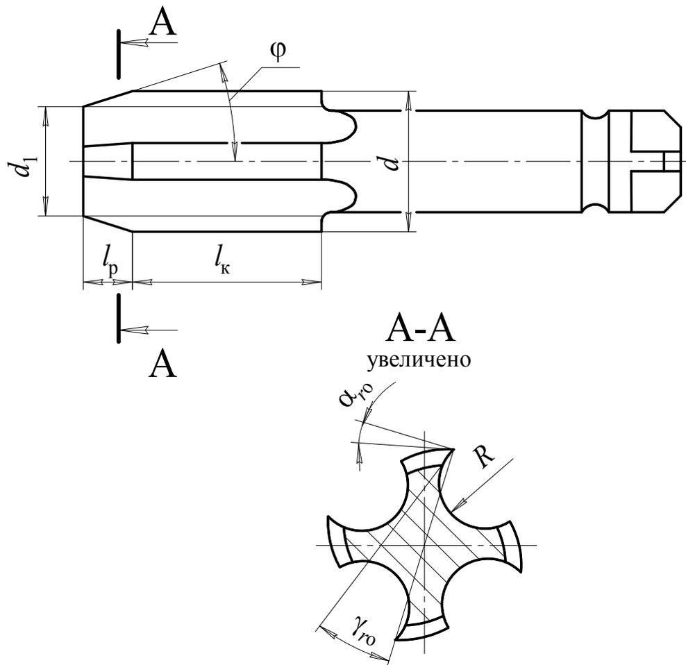
Рис. 4.20. Геометрические параметры метчика с прямыми канавками
