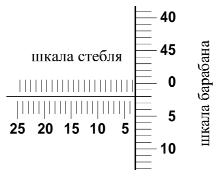
Рис. 5.5. Показания микрометрического инструмента
