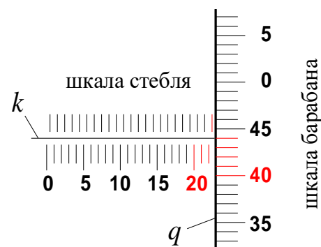
Рис. 5.3. Шкалы микрометра (измеренный размер 22,94 мм)
